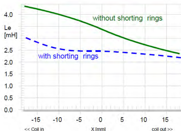
Figura 17: Ejemplo de la inductancia de un altavoz con y sin anillo de cortocircuito.
