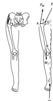
Forças que atuam na perna quando esta carrega o peso total do corpo **
